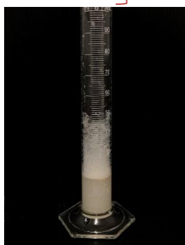
ภาพที่ 1.2 หลังจากการทดสอบพลิกคว่ำไปมา 10 ครั้ง ของทั้ง 3 สূตร F1 (ก), สূตร F2 (ข), สূตร F3 (ค)
