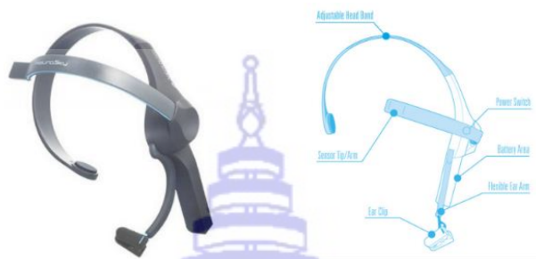
ภาพที่ 1 เครื่องวัดคลื่นสมอง Mindwave Mobile รุ่น Neurosky
