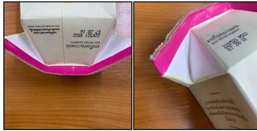
ภาพที่ 5 ลักษณะของเสียจากปัญหาหุกล่องไม่ติด
